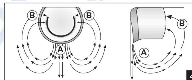
**A** – выдуваемый воздух, который охлаждается при соприкосновении с охлаждающей панелью;
